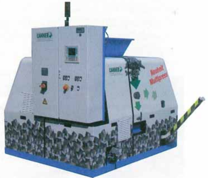
Der Multipress der Firma Lanner fertigt Briketts aus unterschiedlichen Abfällen.
